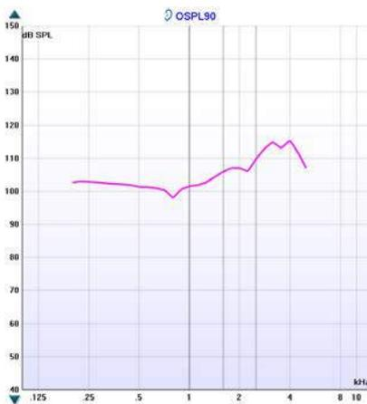
El **gráfico** muestra las curvas HIT medidas. El eje X muestra la frecuencia y el eje Y muestra la salida o la ganancia, según la medición realizada.
