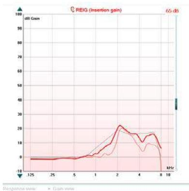
El **Graph** (gráfico) muestra las curvas REM medidas. El eje X muestra la frecuencia y el eje Y muestra la intensidad de la señal de prueba.
