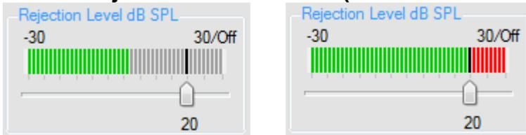
El control deslizante del nivel de rechazo permite configurar el límite de nivel de rechazo entre los -30 y los +30 dB SPL. Los barridos registrados por encima del nivel de rechazo que se haya fijado se considerarán demasiado ruidosos y se rechazarán.
