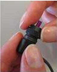
Atornille la tapa de la sonda y la punta de la sonda hasta que queden sujetas y apretadas.
