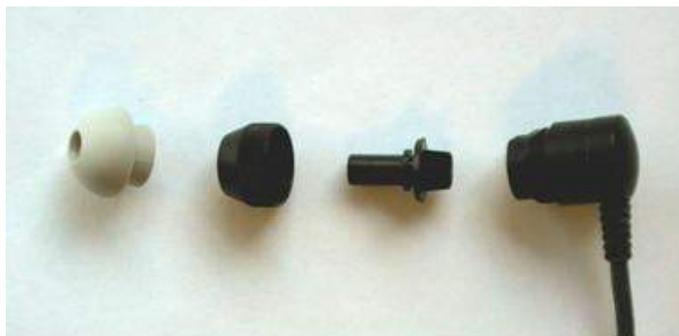
Sonda OAE desmontada
