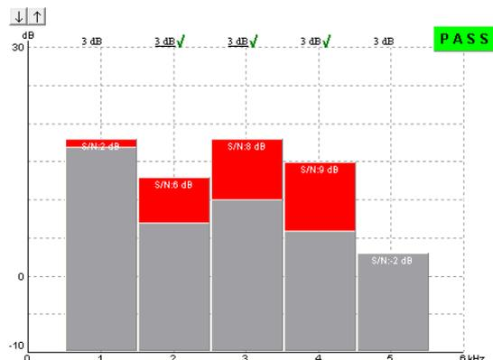
Al ejecutar una prueba de apto/no apto, se muestran marcas de verificación sobre las bandas cuando se cumplen los criterios de parada. Las bandas obligatorias para ser apto se indican con un subrayado.
