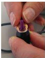
Coloque la herramienta de la punta de la sonda entre la punta de la sonda morada y el borde de la tapa de la sonda negra.
