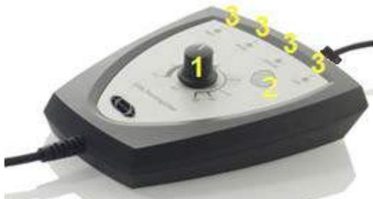
El preamplificador se usa con los módulos ABRIS, EP15, EP25, VEMP y ASSR. Si desea obtener más instrucciones de uso, lea el capítulo correspondiente al módulo.
