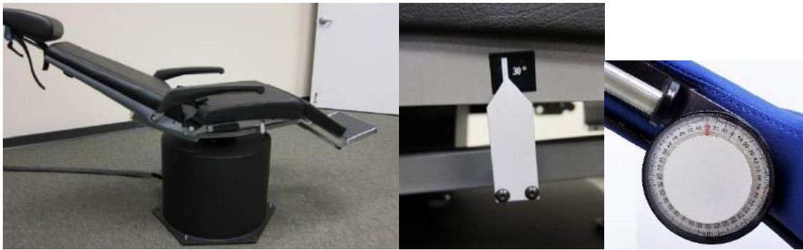
Figura 4.8.3 Sillón reclinado para pruebas calóricas con marcador de ángulo calórico y marcador de inclinación
