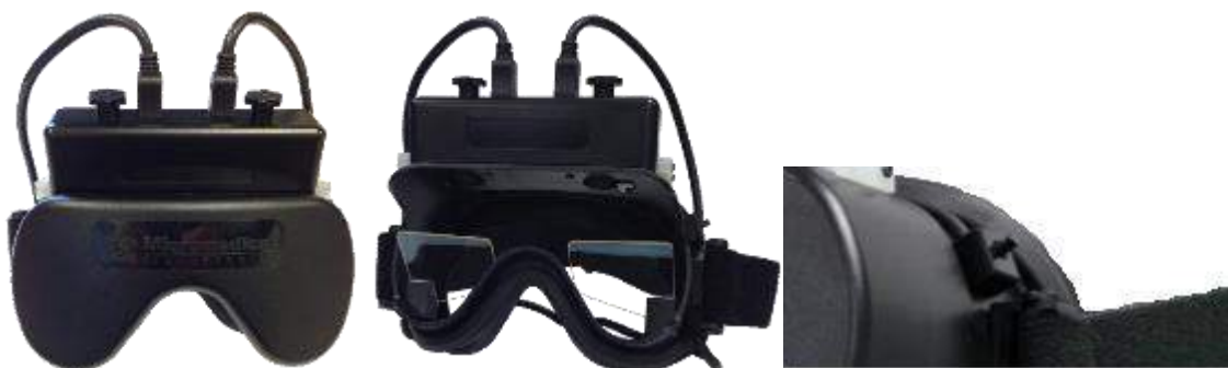
Figura 3.6.5 Gafas con cámara superior. La tapa se desliza en la parte frontal de las gafas para realizar pruebas sin visión. El interruptor en el lateral izquierdo de las gafas inicia y detiene la prueba
